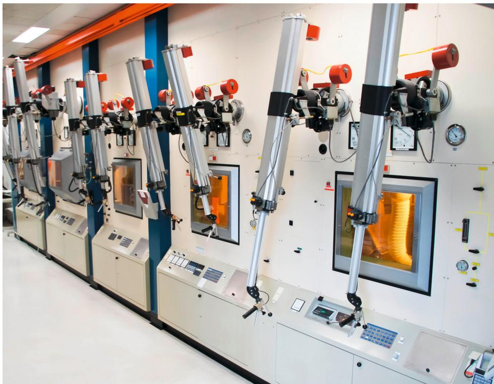
Abb. 4: Produktion von Molybdän-Generatoren in einem GMP-Labor mit entsprechenden Strahlenschutzvorrichtungen (Quelle: C. Töllner, Curium Pharma)
